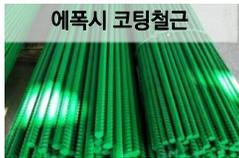
수밀성 에폭시 분체도료를 철근의 표면에 정전 분체도장방식으로 도포하여 약 0.13 mm~0.30 mm로 코팅한 철근
